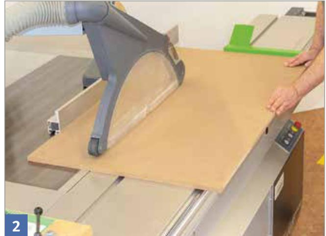
Werkstück an der Rückschlagsicherung anlegen und Schutzhaube auf Werkstückdicke einstellen
