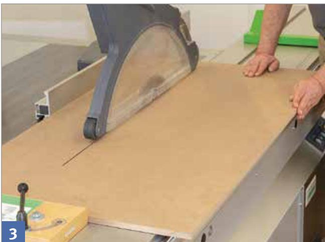
Sägeblatt in vorgesehene Höhe bringen und Werkstück bis zum zweiten Queranschlag vorschieben; dabei Werkstück mit den Händen nur an den Werkstückkanten führen; möglichst großen Abstand zum Sägeblatt halten.
