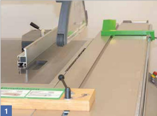
Spaltkeil entfernen, Spaltkeilhalterung festziehen. Schiebetisch feststellen.
