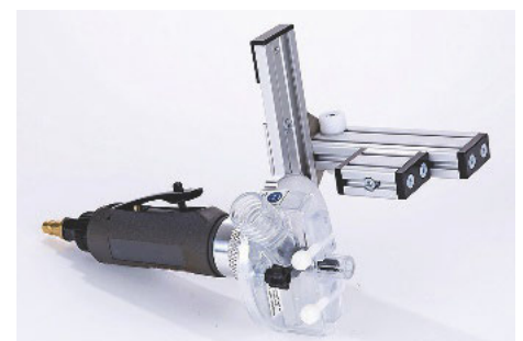
/ Der Eckenrunder-MZ-02-90F wird verwendet, wenn Stirnseiten mit einer Rundung versehen werden.
