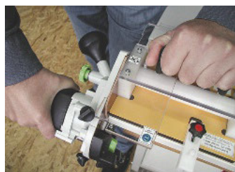
/ ... die MFK 700 von Festool montieren. An der stabile Auflage wird die Fräse ...
