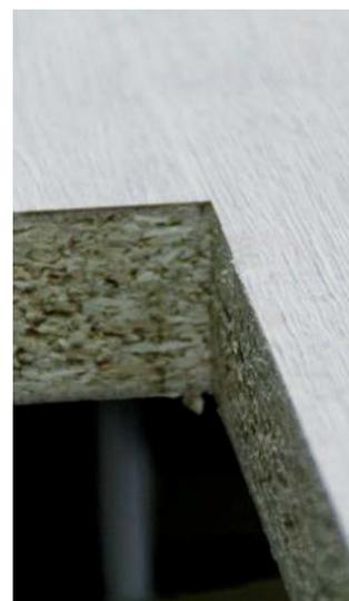
> Vorher – nachher: Die zugeschnittene Platte kommt mit einer Radius-Innenecke in den manuellen Arbeitsplatten-Bearbeitungsbereich bei Häcker Küchen. Nach dem Einsatz des „Eckenauslinkers“ von Dr. Christoph Heßler Maschinensysteme ist die Ecke präzise scharfkantig gefräst.
