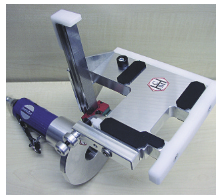
Bild 4: Der praktische Eckenformer in der Gesamtansicht
