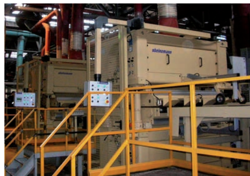
6-головочная система Nova-H в одной из линий производства фанеры в России
