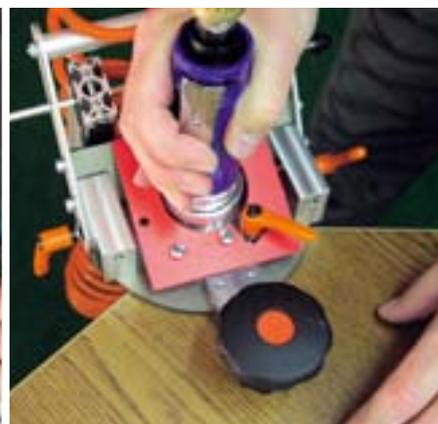
12 ... Nach dem Fräsen der Stirnkanten lassen sich mit dem Gerät auch die Restecken runden
