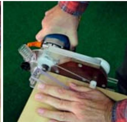
3 ... Außerdem profiliert es die Stirnkanten und fräst die Restecken rund
