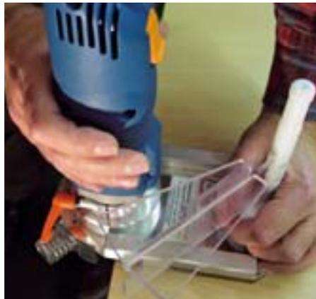
2 ... Es rundet oder fast die Längskanten mit einem Profilfräser mit Anlauflager
