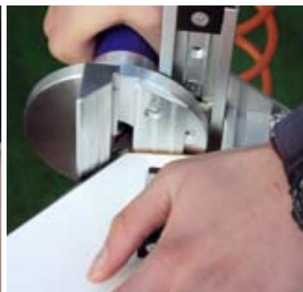
9 ... und fräst dann nach. Das Resteckenrunden erfolgt dann z. B. mit dem MZ 100 90 F
